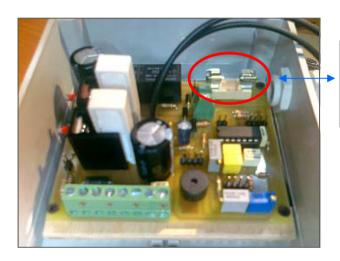
Fusibile da 10 Ampère di protezione cortocircuito lato ingresso corrente (batteria).
