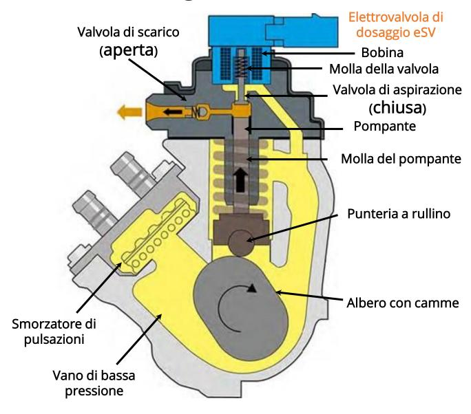
Se vengono effettuate operazioni di manutenzione della fasatura motore <u>occorre</u> regolare anche la corretta posizione di <u>fasatura</u> della pompa di alta pressione.
