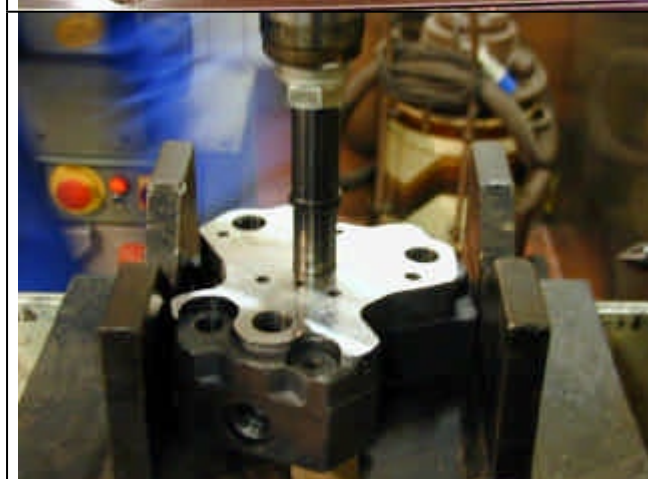
Posizione il corpo pompa su una pressa e utilizzare il tampone (N°1 per CP3/70 e N°2 per CP3/80-110) per estrarre la boccola.
