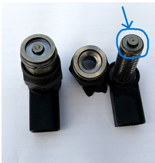
La parte terminale del cilindro è saldata alla lamiera visibile sul fondo dell'attuatore che ora si vede deformata
